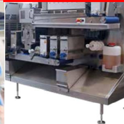
Nachylone powierzchnie i wysokie prześwity
